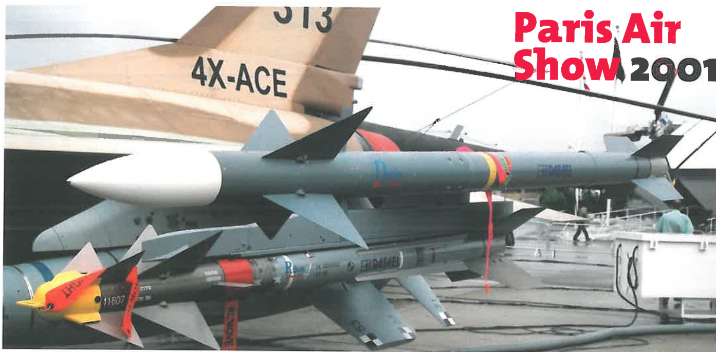
Den israeliska radarjaktroboten Derby är försedd med nosroder och fasta stjärtfenor. Den är troligen utvecklad med IR-roboten Python 4 som grund.
