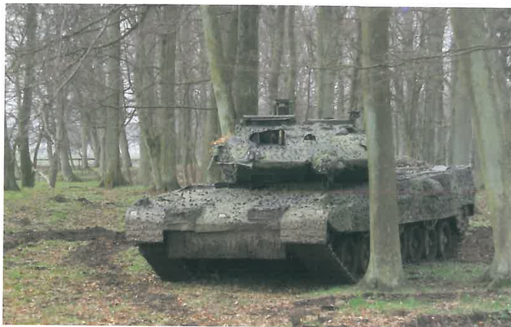
Stridsvagn 122 med nytt maskeringssystem som reducerar både IR- och mikrovågssignatur.
