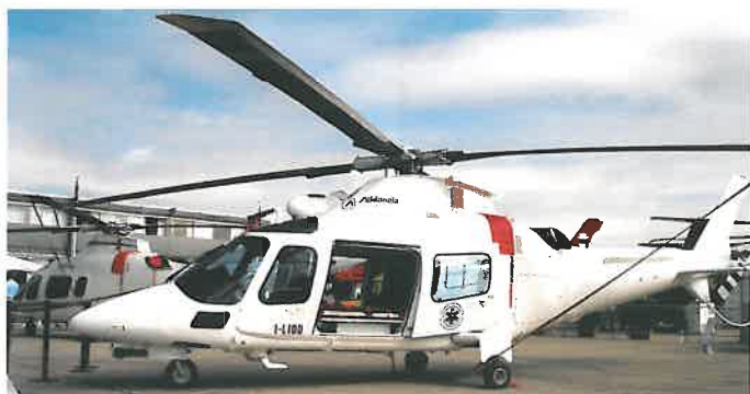
FMV undertecknade under mässan ett avtal om anskaffning av 20 st Augusta 109 LUHS (HKP15). Max startvikt är 3 ton och helikoptern kan ta 7 passagerare + pilot. På bilden en civil ambulansversion.
