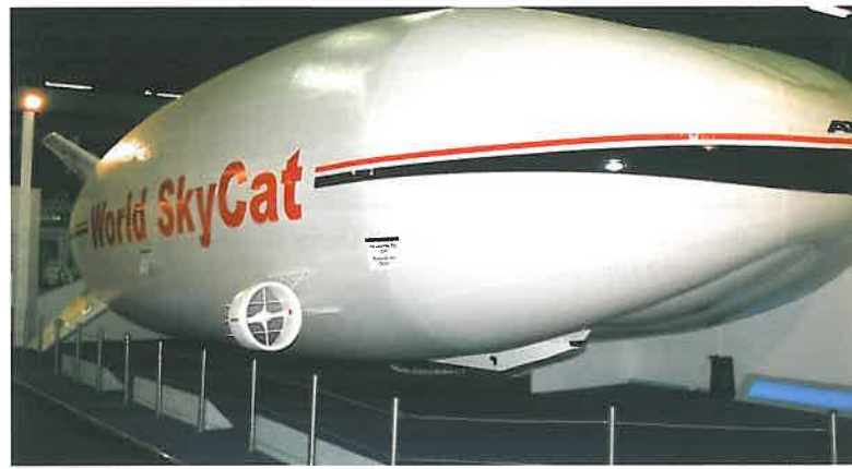
Det brittiska företaget Advanced Technologies Group, ATG, presenterade en modell av SkyCat 20, som är en hybrid mellan luftskepp, svävare och flygande vinge. SkyCat 20, med en lastkapacitet på 20 ton är avsedd att användas för militära och civila fraktändamål, övervakning, humanitära hjälpinsatser, reklam och turiständamål.
