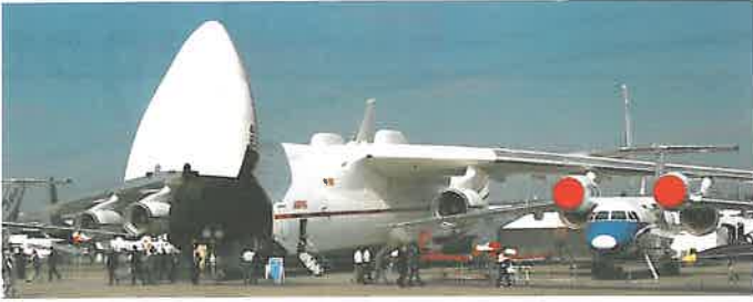
Transportflygplanet An-225 visades på den statiska utställningen. Flygplanets tomvikt är 220 ton och maximal startvikt är hela 600 ton. Landningsstället består av totalt 12 par hjul.
