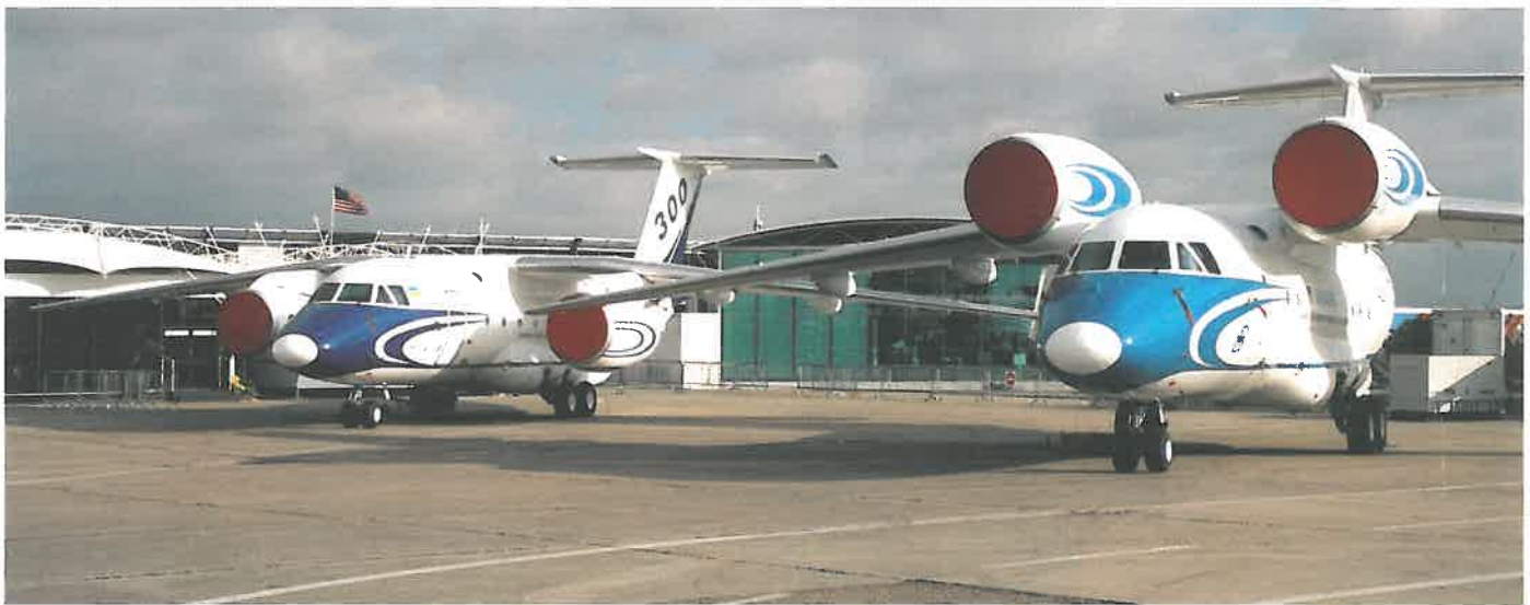
Den ryska passagerarflygplanet An-74TK-300 (till vänster) gjorde internationell debut på Le Bourget. Första flygningen skedde i april 2001 och flygplanet hade innan mässan genomfört 35 flygningar. Den största skillnaden jämfört med ursprungsversionen av An-74 är att motorerna har placerats på undersidan av vingarna istället för översidan, som var ett militärt krav från början. Den mer normala placeringen under vingarna medför bättre bränsleekonomi.
