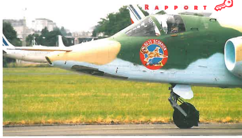
Su-26 Scorpion taxar inför den dagliga flyguppvisningen. I nosen är en laserbelysare/avståndsmätare placerad. Den tvåpipiga automatkanonen strax bakom har en kaliber på 30 mm.
