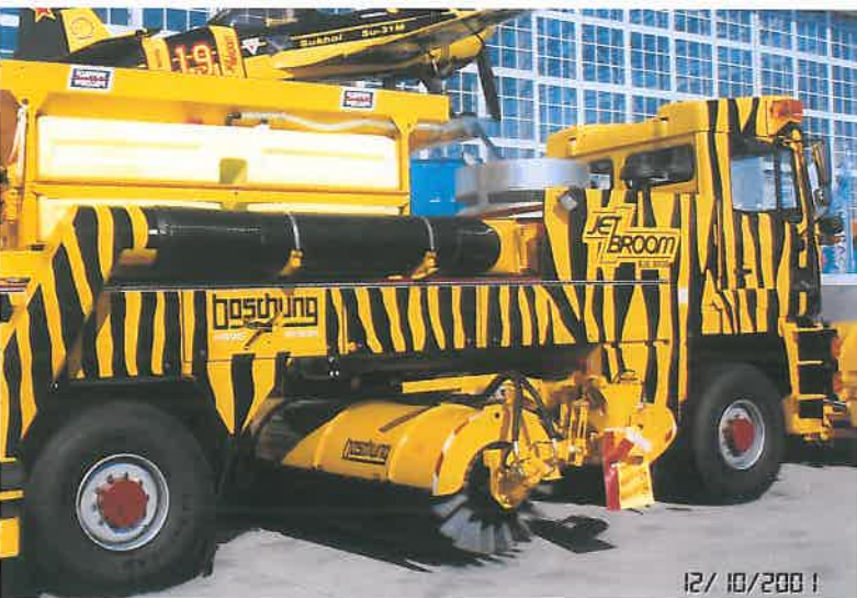
Kombinerad spridare sopblås och plog. Foto: Åke Johansson, FMV.
