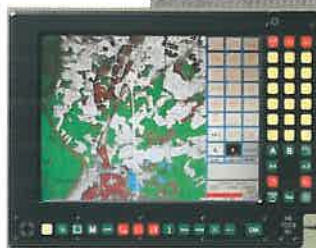
Vagnchefens monitor för ledningsstödsystemet TCCS.
